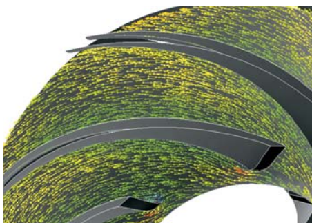
複数のローターブレード間にある平面の 相対速度ベクトル
