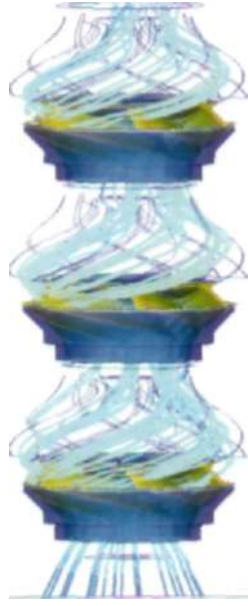
Tasarımda kullanılan hesaplamalı akışkanlar dinamiği (HAD) çözümlemesi.
